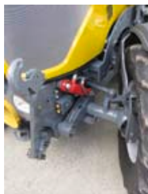
La suspension de l'essieu avant assure un confort de premier ordre.
