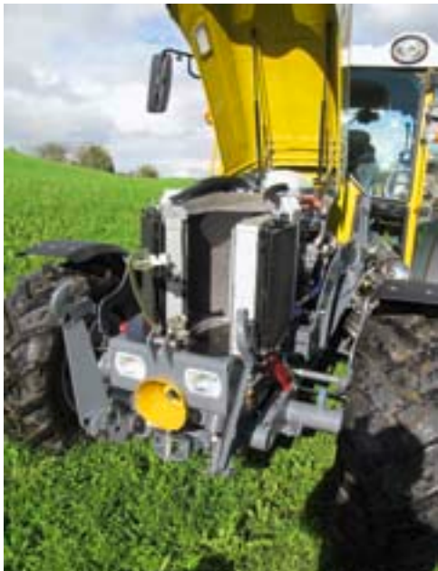
Die in einem Dreieck angeordneten Kühler sind für die Reinigung sehr gut zugänglich.
