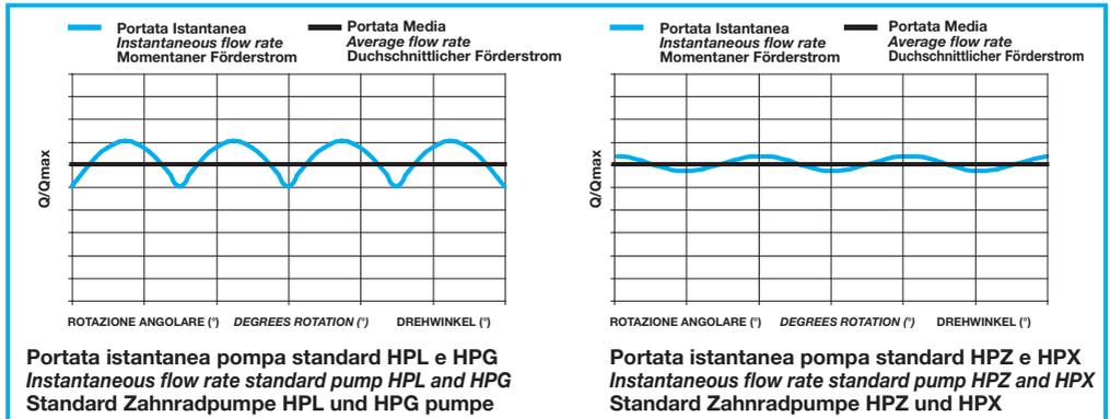
HP Hydraulic SpA ha sviluppato due gamme di pompe a ingranaggi a dentatura elicoidale. HPZ è la gamma di pompe silenziose in alluminio del gruppo 2 dedicate alle applicazioni mobili e agricole nelle quali è richiesto un abbattimento considerevole del livello di pressione sonora (dB(A)).
